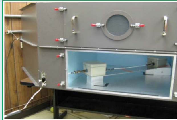
b) TEM cell을 이용한 공간 차폐도 시험 장비
