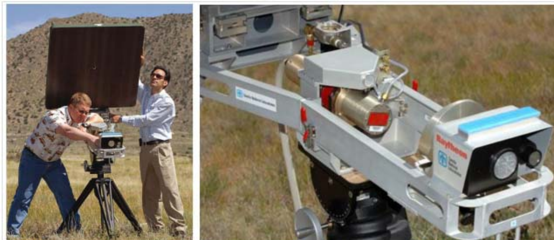
미국 Sandia 연구소, Raytheon technology 개발 95GHz 단방향 비핵전자기파 발생기
