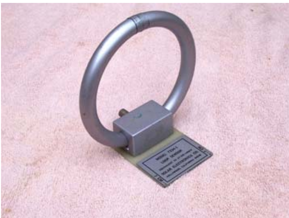
그림 3. Solar Electronics 가 AT-205/URM-6 대응으로 제안한 Model 7334-1 루프
