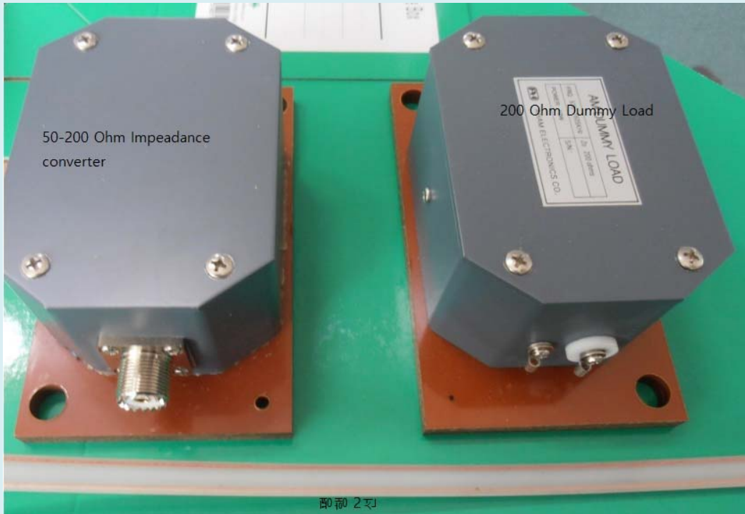
그림15. 평행2선 방식의 10kHz-1MHz 대역 여진장비 Set
